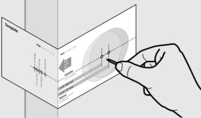
Marque el orificio en el frente de la puerta. Seleccione la distancia al centro deseada antes de marcar el orificio. Si existe otro orificio en la puerta, o si está perforando puertas dobles, asegúrese de mantener consistente la distancia del frente a la bocallave.
