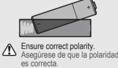
**C** Insert battery pack and push in gently until you hear "click". Inserte la batería y empuje suavemente hasta que oiga un «clic».
