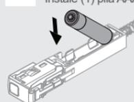
**D** Insert battery pack and push in gently until you hear "click". Inserte la batería y empuje suavemente hasta que oiga un «clic».
