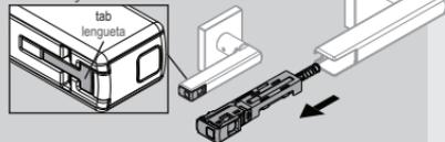
**B** Remove battery. Retire la batería.
