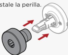
Alinee los orificios del pomo y la base del pomo antes de apretar el tornillo de fijación preinstalado.
