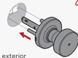
**! IMPORTANTE:** En caso de instalar una cerradura de paso en la entrada de una puerta, asegúrese de que la perilla con los orificios de los tornillos está en el lado interior de la puerta.
