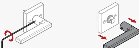
afloje los tornillos de ajuste preinstalados
