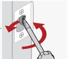
Cierre la puerta y compruebe el funcionamiento del tirador. Si el pestillo está flojo en el cerradero, ajuste la lengüeta del cerradero para que sujete mejor el pestillo cuando la puerta esté cerrada.
