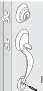
Si se taladra hasta el fondo a través de la madera puerta, utilice tornillos "J" y "K".
