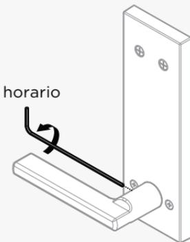
⚠ Apriete a fondo el tornillo de fijación utilizando el extremo largo de la llave Allen.
