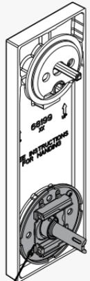
Si es necesario un ajuste manual, desmonte y gire el chasis.
