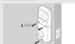
Reinstale la tapa interior y asegúrese de que el pestillo está en la posición desbloqueada.
