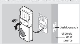
Asegúrese de que la paleta de torsión está en la posición horizontal. Instale el ensamble interior.
