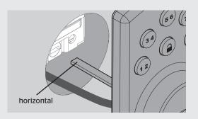
Inserte la paleta de torsión a través del orificio ranurado en el pestillo.
