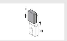
B Instale 4 baterías AA en el ensamble interior. Para mejores resultados, utilice nuevas baterías tipo alkalina no recargables.
