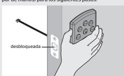
Inserte la paleta de torsión a través del orificio central de la placa de montaje y inserte el cable a través del orificio inferior.
