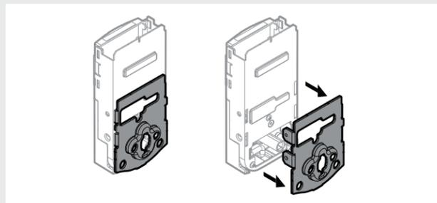
**D** Instale el teclado exterior y la placa de montaje.
