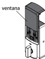
Para mayor seguridad, puede elegir bloquear la ventana instalando el tornillo de seguridad.
