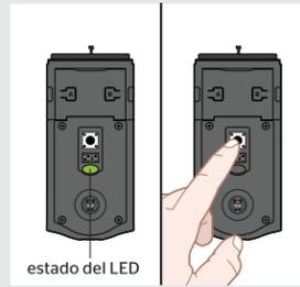
**D** El perno de retención se retrae y se extiende por sí solo para conocer la orientación de la puerta. ¿El estado del LED se volvió verde o rojo?
