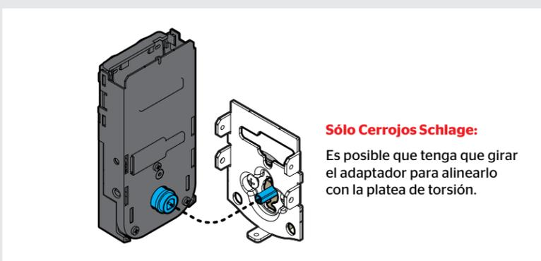
**D** Fije el ensamblaje interior con dos (2) tornillos suministrados.
