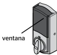
Si se desbloquea la ventana, se puede deslizar hacia arriba para un acceso rápido a los botones mientras se instala la tapa.
