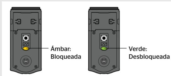
**B** Utilice la llave para bloquear y desbloquear la puerta y verificar que El estado del LED se está comunicando correctamente.
