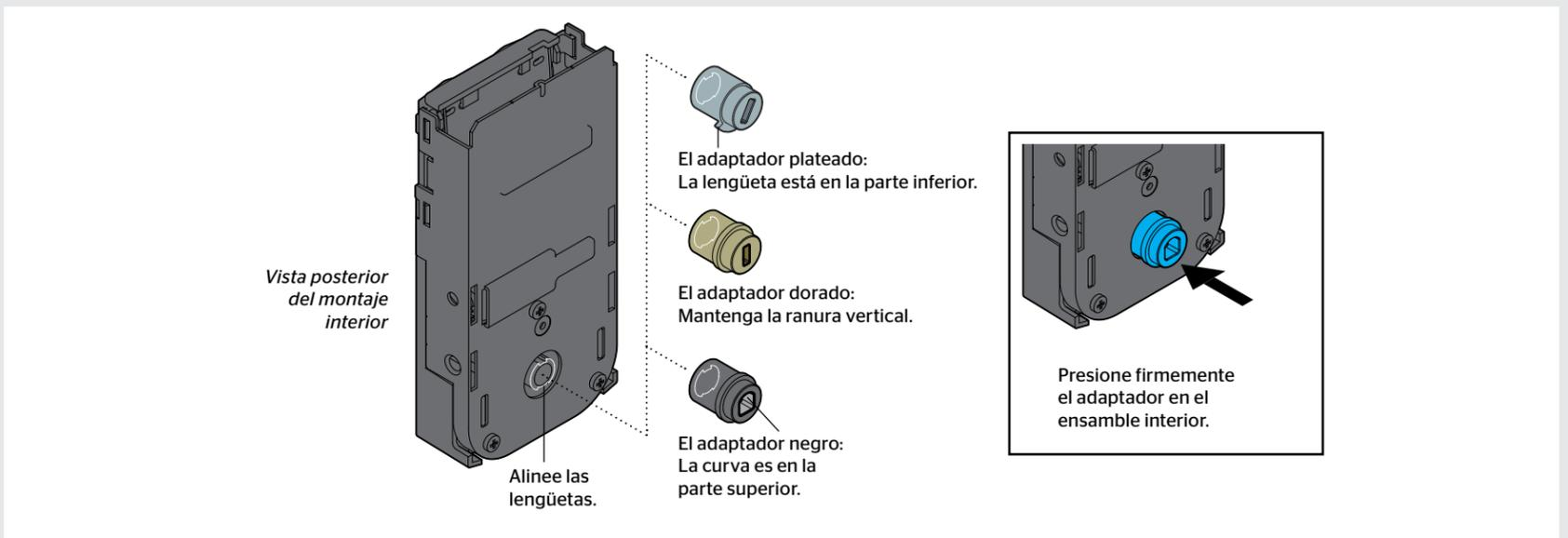
**C** Alinee el adaptador con la placa de torsión y empuje el conjunto interior sobre la placa de montaje.
