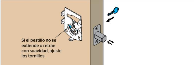
**D** Retire la llave y compruebe que el perno de retención esté extendido por completo.
