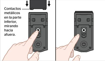
**C** El estado del LED titila en color rojo y verde, y la cerradura emite un pitido. **Presione y suelte el botón Programa nuevamente.** El perno de retención se retraerá y extenderá por sí solo.
