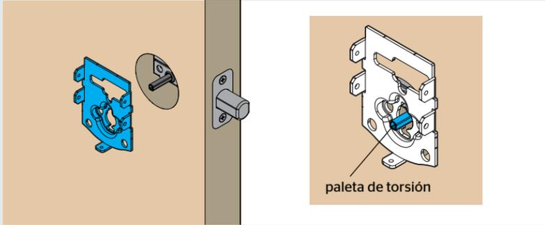
Nota: Se muestra una paleta de torsión en forma de "D," pero la instalación es la misma para todos los modelos
