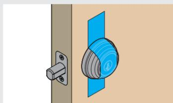
**F** Retire las piezas del cerrojo existente del lado interior de la puerta.
